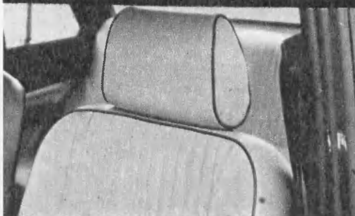
«Москвич—2140». Новый подголовник (слева), рукоятка для регулировки наклона спинки.
