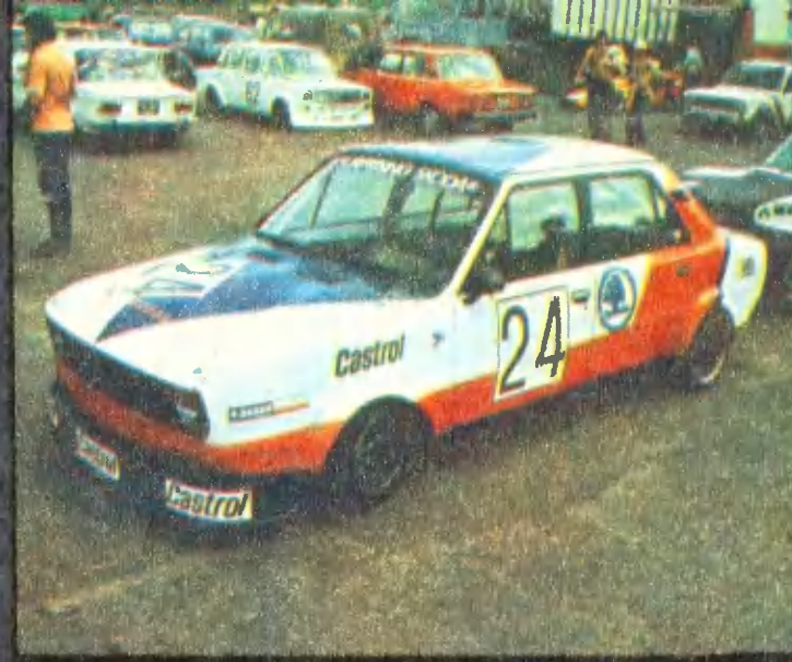
«ШКОДА-120С» (ЧССР) — машина с двигателем, расположенным сзади, и независимой подвеской всех колес.
